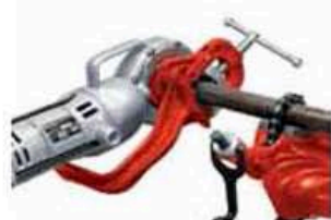
Roscado utilizando una llave de tuberías como brazo de soporte
