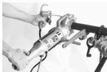
Roscado utilizando una llave de tuberías como brazo de soporte
